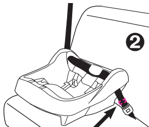
La traba de seguridad va aquí, a media pulgada de la hebilla
