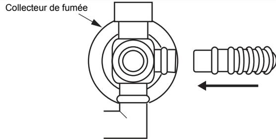
3. Adaptez la fermeture de tuyau sur le raccordement entre le coude de cheminée et le collecteur. Engagez le crochet et tournez-le jusqu'à ce qu'il s'enclenche contre le corps de l'étrier.
