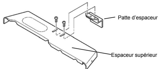
6. Mettez en place le support mural avec deux vis. Installez l'espaceur supérieur en insérant sa patte dans le support mural et en le fixant sur le chauffage avec 2 vis.
