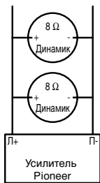
Мостовое соединение 4 Ω
