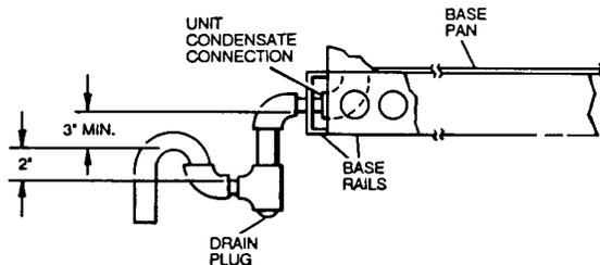
**FIGURE 4 : RECOMMENDED DRAIN PIPING**
