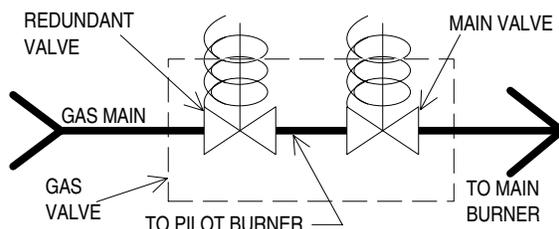
**FIGURE 14 : GAS VALVE PIPING**
