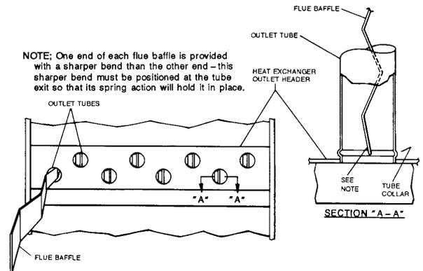
**FIGURE 21 : TYPICAL FLUE BAFFLE INSTALLATION**
