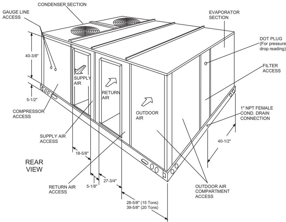
**FIGURE 12 : UNIT DIMENSIONS DHE/DHG180 & 240 (REAR VIEW)**
