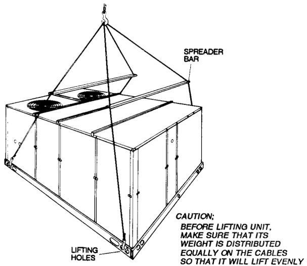
**FIGURE 1: TYPICAL RIGGING**
