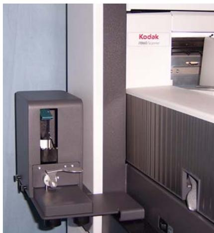
1. Выньте картридж принтера из сканера. Инструкции см. в разделе "Установка нового картриджа принтера".
