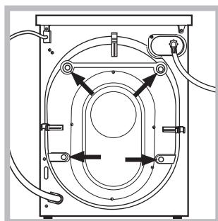
3. Tire os parafusos de protecção para o transporte e a borra-chinha com o respectivo calço, situados na parte traseira (veja a figura).
