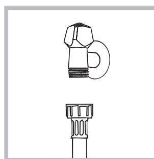
1. Collegare il tubo di alimentazione avvitandolo a un rubinetto d'acqua fredda con bocca filettata da 3/4 gas (vedi figura). Prima di allacciare, far scorrere l'acqua finché non sia limpida.
