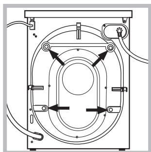
3. Quite los tornillos de protección para el transporte y la arandela de goma con el correspondiente distanciador ubicados en la parte posterior (*ver la figura*).
