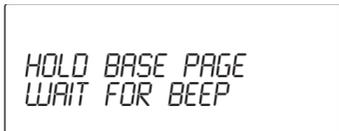
2. Gardez enfoncé le bouton de recherche sur le socle des modèles GE 21018 et 21028 ou le bouton PAGE/INT sur le socle du modèle 21098 jusqu'à l'obtention d'une longue tonalité. Le combiné affiche HANDSET # REGISTERED (combine # entegistre), suivi de HANDSET NAME (combine nom).
