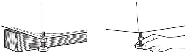
Si la laveuse est placée contre un mur, on doit l'écartier légèrement du mur avant de l'incliner vers l'arrière. Si la laveuse n'est pas d'aplomb, soulever d'abord l'avant à l'aide d'un bloc de bois et régler la hauteur des pieds avant en déplaçant la pièce en plastique hexagonale si nécessaire. Répéter pour le réglage des pieds arrière.
