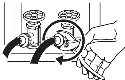
**REMARQUE :** Ne pas serrer excessivement. Le raccord ou le robinet risque d'être endommagé. Les deux robinets doivent être utilisés pour un fonctionnement approprié de la laveuse.
