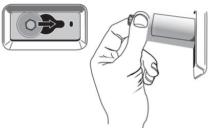
3. Une fois que les 4 boulons ont été retirés, jeter les boulons et les cales d'espacement. Puis tirer le cordon d'alimentation à travers l'ouverture du panneau arrière et obturer le trou avec le bouchon fourni.
