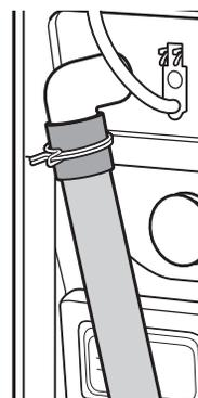
4. Le système de vidange de la laveuse peut être installé à l'aide d'un conduit d'évacuation au plancher, un tuyau de rejet à l'égout au plancher (rigide) ou un évier de buanderie.
