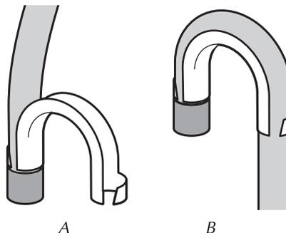
A. Emboîter une extrémité ou l'autre de la bride de retenue pour tuyau de vidange sur le tuyau de vidange, au point de commencement des ondulations.
