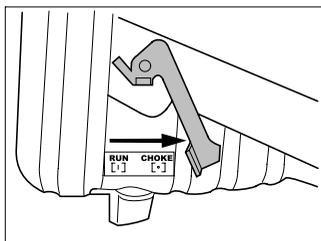
Después de que el motor se haya calentado y marche lentamente, **mueva la palanca del ESTRANGULADOR a la posición RUN como se indica.**
