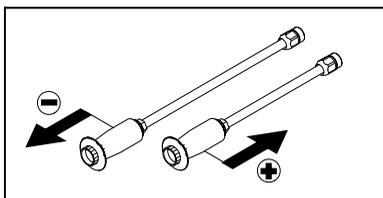
quierda o hacia la derecha para cambiar de tipo de pulverización entre chorro en punta y chorro plano.
