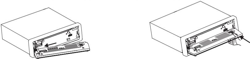
3. PUSH IT TO INSTALL THE FRONT PANEL COMPLETELY .
