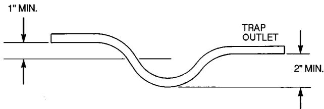
Fig. 27 — Condensate Trap
