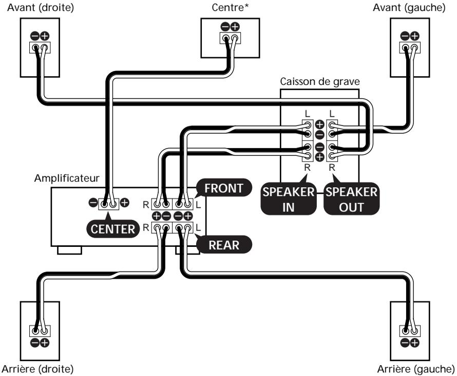
\* (SA-VE505 seulement) Raccordez l'enceinte centrale à l'amplificateur et mettez-la sur le pied d'enceinte fourni pour l'installer sur un téléviseur (voir page 7).
