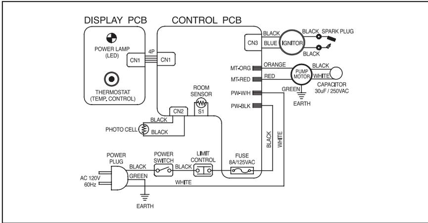
**D) WIRING DIAGRAM (RMC-KFA210T)**
