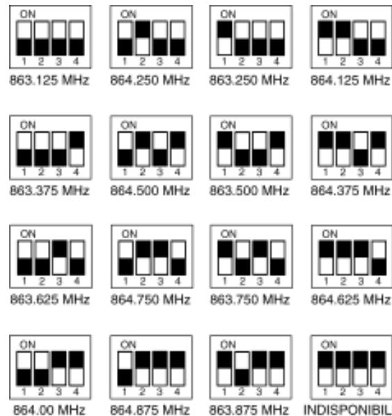
Orientare i dip switch del ricevitore e il trasmettitore palmare o a cintola sulla frequenza corrispondente. I dip switch del ricevitore sono situati sul pannello frontale. I dip switch del trasmettitore a cintola si trovano a lato di esso. I dip switch del radiomicrofono palmare sono accessibili aprendo il portabatterie a lato del microfono.
