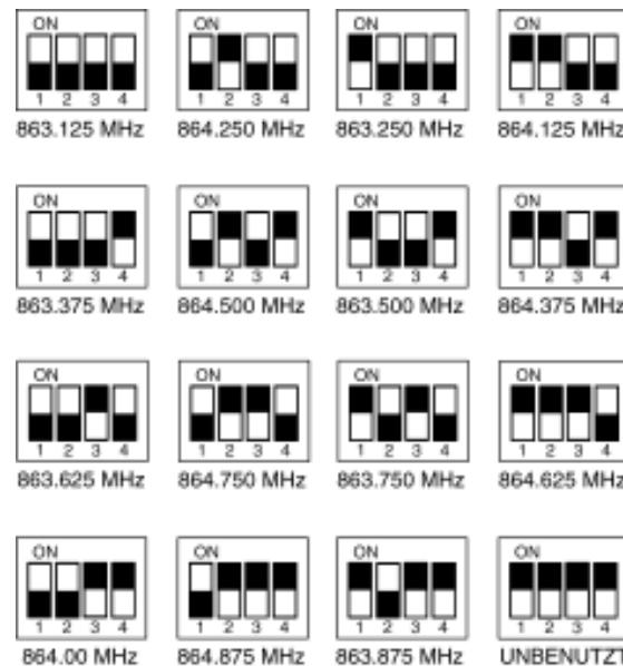
Die Dip-Schalter auf dem Empfänger, Gürtelsender oder Handmikrofon-Sender auf die entsprechenden Frequenzen justieren. Die Dip-Schalter für den Empfänger befinden sich auf der Frontplatte. Die Dip-Schalter für den Gürtelsender befinden sich an der Seite des Gürtelsenders. Die Dip-Schalter für das Handmikrofon sind zugänglich, indem Sie den Batteriehalter an der Seite des Empfängers öffnen.
