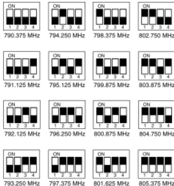
Ajuste los microconmutadores en el receptor y en el transmisor llevado en el cinturón o en el transmisor-micrófono manual para que las frecuencias correspondan. Los microconmutadores para el receptor se encuentran en el panel frontal. Los microconmutadores para el transmisor llevado en el cinturón se encuentran en el lado del conjunto de cinturón. Los microconmutadores para el micrófono manual son accesibles al abrir el portapilas en el lado del micrófono.
