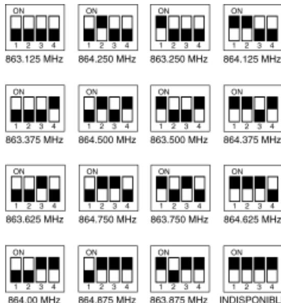
Réglez les microcommutateurs sur le récepteur et l'émetteur porté à la ceinture ou l'émetteur micro main afin d'obtenir des fréquences correspondantes. Les microcommutateurs pour le récepteur sont situés sur le panneau avant. Les microcommutateurs pour l'émetteur porté à la ceinture sont situés sur le côté de l'ensemble ceinture. Les microcommutateurs pour le micro main peuvent être réglées en ouvrant le porte-piles situé à l'extrémité du micro.
