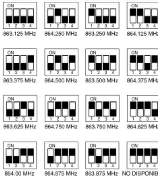
Ajuste los microconmutadores en el receptor y en el transmisor llevado en el cinturón o en el transmisor-micrófono manual para que las frecuencias correspondan. Los microconmutadores para el receptor se encuentran en el panel frontal. Los microconmutadores para el transmisor llevado en el cinturón se encuentran en el lado del conjunto de cinturón. Los microconmutadores para el micrófono manual son accesibles al abrir el portapilas en el lado del micrófono.
