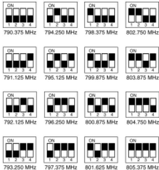
Réglez les microcommutateurs sur le récepteur et l'émetteur porté à la ceinture ou l'émetteur micro main afin d'obtenir des fréquences correspondantes. Les microcommutateurs pour le récepteur sont situés sur le panneau avant. Les microcommutateurs pour l'émetteur porté à la ceinture sont situés sur le côté de l'ensemble ceinture. Les microcommutateurs pour le micro main peuvent être réglées en ouvrant le porte-piles situé à l'extrémité du micro.
