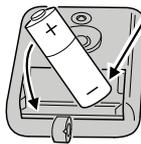
PUSH POSITIVE (+) END INTO TRANSMITTER LAST
