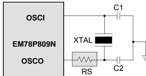
Fig. 31. Crystal/Resonator Circuit
