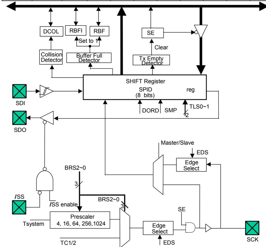
Fig. 14. SPI Block Diagram
