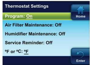
**Program** (Programa) – El valor predeterminado es **On** (Activado). Seleccione **Off** (Desactivado) para inhabilitar los programas de calefacción y enfriamiento y mantener una temperatura constante las 24 horas del día.
