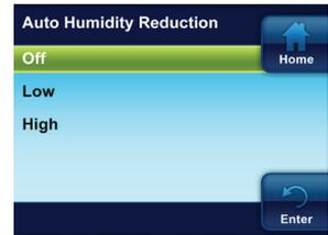
**Comfort or Dehum** (Confort o deshumidificación) – El valor predeterminado es **Off** (Desactivado). Cuando se selecciona la opción **Comf**, la temperatura se altera por la humedad para reflejar el confort verdadero. Cuando selecciona **Dehum**, la reducción de humedad seleccionada se maximiza y sigue enfriando más allá del punto de referencia de temperatura.
