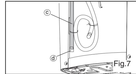
**Mise En Garde:** Oublier de remplacer et réinstaller le bouchon sur le tuyau d'évacuation avant d'employer l'appareil occasionnera une inondation.
