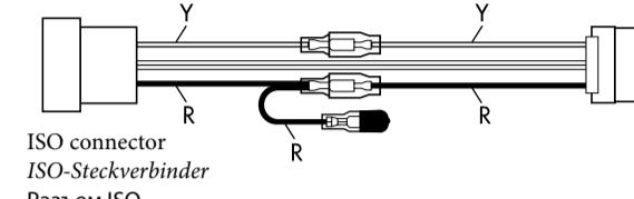
Modified wiring 1 / Modifizierte Verdrahtung 1 / Преобразованная схема соединений 1
