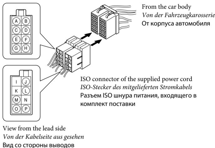
**For some VW/Audi or Opel (Vauxhall) automobile / Bei bestimmten VW-/Audi- oder Opel (Vauxhall)-Fahrzeugen / Для некоторых автомобилей VW/Audi или Opel (Vauxhall)**
