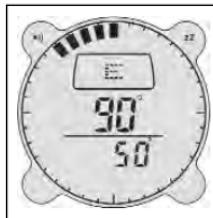
drücken, um die erwünschte Orientierung einzustellen. Durch Drücken auf Up oder Down wird die Einstellung in Zehnerschritten erhöht oder gesenkt. Ein einziger Druck auf Up oder Down bewegt die Orientierung um 1 Grad. Nach Beendigung auf **ADJ** drücken, um zur Funktion Homing Mode zurückzuziehen. Durch Druck auf den Button Mode gelangen Sie zur Funktion Compass Mode zurück.
