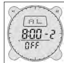
O alarme também pode ser ligado ou desligado movimentando-se até o alarme relevante e pressionando o botão **COMP** para ativar a função de alarme; pressione novamente para ativar a função Snooze, e mais uma vez para desativar o alarme.
