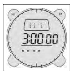
Quando l'allarme suona, premete un pulsante qualsiasi per arrestare il conteggio alla rovescia. Se non si preme nessun pulsante, l'allarme cessa dopo 10 secondi ma il timer continua a funzionare se la funzione 'AUTO' è inserita. In quest'ultimo caso, per arrestare il conteggio alla rovescia occorre passare alla modalità Conteggio alla rovescia, premere COMP per disinserire la funzione 'AUTO' e poi premere UP per arrestare il conteggio.
