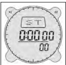
Para acessar a função de divisão de tempo, pressione o botão **DOWN** enquanto o cronômetro estiver operando para interromper o display e pressione novamente para continuar. Você pode também pressionar o botão **DOWN** enquanto o cronômetro estiver operando para interromper o display e pressionar o botão **UP** para interromper o cronômetro e exibir a leitura final. Pressione o botão **DOWN** novamente para zerar o cronômetro.
