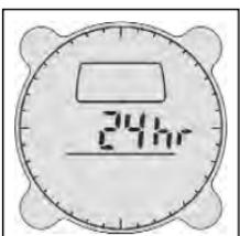
Para ajustar o horário na configuração de 24/12 horas, pressione o botão **MODE** até que seja exibido Modo de horário. Pressione e mantenha o botão **ADJ** pressionado por 3 segundos. Pressione o botão **MODE** e percorra as configurações até que apareça o ajuste de horário 24/12. Depois, pressione o botão **UP** ou **DOWN** para estabelecer o ajuste desejado. Pressione o botão **ADJ** a qualquer momento para salvar as mudanças e sair.
