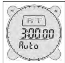
Para ajustar o cronômetro de contagem regressiva, pressione e mantenha o botão **ADJ** pressionado por 3 segundos. Isso fará com que o ajuste dos segundos comece a piscar. Ajuste com o botão **UP** ou **DOWN**, em seguida pressione o botão **MODE** para ajustar a próxima configuração. Pressione **ADJ** para salvar os ajustes e sair. Pressione **COMP** para 'AUTO' a fim de que o cronômetro de contagem regressiva repita a função automaticamente e pressione mais uma vez para desligar essa função.
