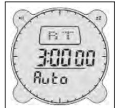
Para fijar el Temporizador de cuenta atrás, pulse y mantenga pulsado el botón ADJ durante tres segundos, lo cual hará que destelle la posición de segundos. Ajuste con el botón UP o DOWN, y luego pulse el botón MODE para fijar la siguiente posición. Pulse el botón ADJ para guardar los ajustes y salir. Pulse COMP y entre en 'AUTO' para permitir que el Temporizador de cuenta atrás repita la función automáticamente, y pulse COMP otra vez para apagar la función 'AUTO'.
