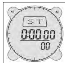
Pour la fonction de chronométrage fractionné, appuyez sur le bouton DOWN pendant le fonctionnement du chronomètre afin d'arrêter l'affichage et appuyez de nouveau pour continuer. Vous pouvez aussi appuyer sur le bouton DOWN pendant le fonctionnement du chronomètre afin d'arrêter l'affichage puis appuyer sur le bouton UP pour arrêter le chronomètre et afficher le relevé final. Appuyez de nouveau sur le bouton DOWN pour remettre le chronomètre à zéro.
