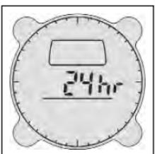
Pour le réglage 24/12 heures, appuyez sur le bouton **MODE** jusqu'à ce que Time Mode (mode temps) soit affiché. Maintenez **ADJ** enfoncé pendant 3 secondes. Appuyez sur le bouton **MODE** et faites défiler les réglages jusqu'à ce que le réglage 24/12 heures apparaisse puis appuyez sur le bouton **UP** ou **DOWN** pour entrer le réglage souhaité. Appuyez sur le bouton **ADJ** à n'importe quel moment pour sauvegarder les changements et sortir.
