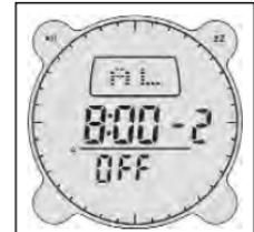
Il est aussi possible d'activer et de désactiver l'alarme en accédant à l'alarme appropriée et en appuyant sur le bouton **COMP** pour activer la fonction d'alarme, en rappuyant pour activer la fonction de rappel et en rappuyant pour désactiver l'alarme.
