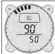
o abajo aumentará o disminuirá el rumbo en incrementos de diez. Una simple pulsación arriba o abajo mueve el rumbo 1 grado. Cuando termine, pulse el botón **ADJ** para regresar a la Modalidad de indicador de rumbo (Homing mode). Para volver a la Modalidad de brújula (Compass Mode) pulse el botón **Mode**.
