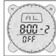
Die Aktivierung oder Deaktivierung des Alarms können Sie auch vornehmen, indem Sie zum entsprechenden Alarm gehen und den Button **COMP** drücken, um die Alarmfunktion zu aktivieren. Erneutes Drücken aktiviert die Schlummerfunktion (Snooze). Durch erneutes Drücken wird der Alarm wieder deaktiviert.
