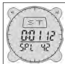
Für die Zeitteilungsfunktion während des Betriebs der Stoppuhr den Button **DOWN** drücken, um die Anzeige zu stoppen und erneut drücken, um weiterzumachen. Sie können den Button **DOWN** während des Betriebs der Stoppuhr auch drücken, um die Anzeige zu stoppen, und dann den Button **UP** drücken, um die Stoppuhr zu stoppen und die letzte Messung anzuzeigen. Den Button **DOWN** erneut drücken, um die Stoppuhr zurückzustellen.
