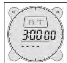
Beim Ertönen des Alarms kann der Countdown Timer durch Drücken eines beliebigen Buttons gestoppt werden. Erfolgt keine Eingabe, hört das Piepen des Countdown Timer nach 10 Sekunden wieder auf, geht aber weiter, wenn die Funktion ‚AUTO‘ eingestellt ist. Zum Stoppen des Countdown Timer bei eingestellter Funktion ‚Auto‘ zur Funktion Countdown Timer Mode gehen und **COMP** drücken. Dadurch wird die Funktion ‚Auto‘ ausgeschaltet. Dann zum Stoppen den Button **UP** drücken.
