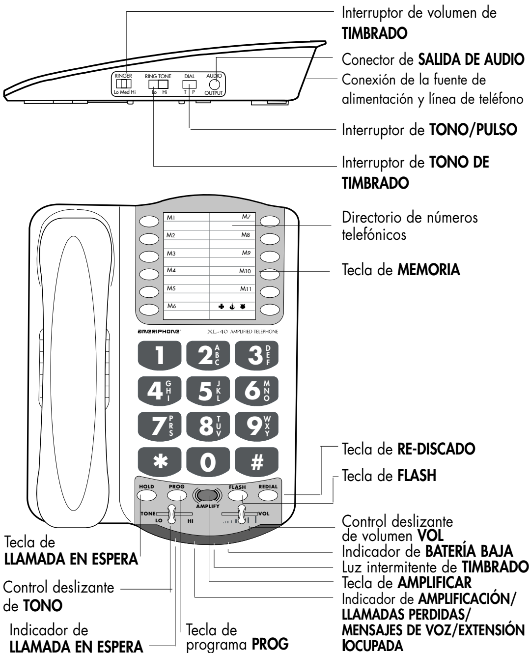
Figura 2 - Controles de la Unidad Base
