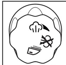
7. Pour arrêter le fer à repasser, placer le commutateur de réglage de la vapeur à la position ☒ (Repassage à sec). Ramener le bouton de sélection de la température à la position ARRÊT. Débrancher le fer à repasser.
