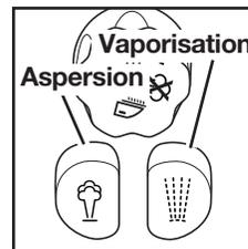
pour une aspersion de vapeur supplémentaire. Appuyer sur le bouton de vaporisation pour projeter un fin brouillard d'eau pour les faux plis
