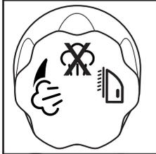
3. Gire la Perilla de control de temperatura a la temperatura deseada. Espere dos minutos hasta que la plancha alcance la temperatura deseada.
