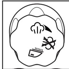
7. Para apagar la plancha, configure la Perilla de vapor ajustable en ☒ (Planchado en seco). Gire la Perilla de control de temperatura a la posición OFF (apagado). Desenchufe la plancha.
