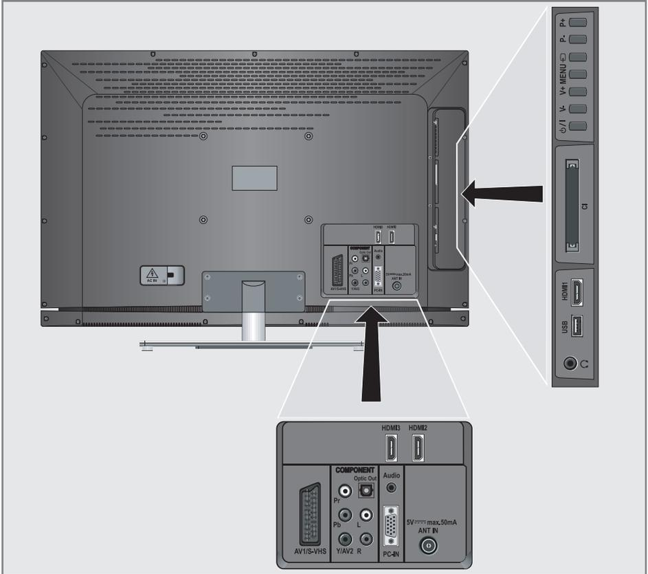
**AV1 / S-VHS** Euro/AV-Buchse (FBAS-Signal, RGB-Signal); Bildsignal-Buchse für S-Video-Camerarecorder.
