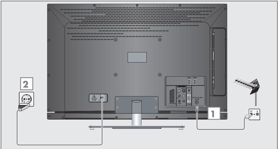
**1a** Zum Empfang terrestrischer Digitalsender (DVB-T) das Kabel der Haus- oder Zimmerantenne (passive oder aktive Zimmerantenne mit eigener Stromversorgung) an die Antennenbuchse »ANT IN« des Fernsehgerätes anschließen;
