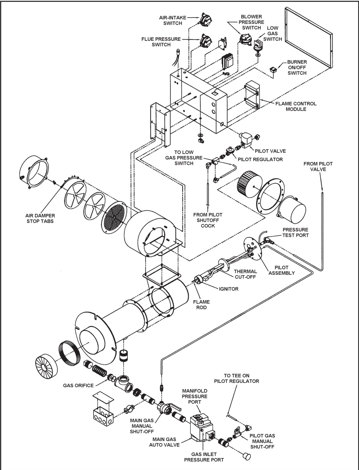
PREMIX LOW NO<sub>x</sub> BURNER - EXPLODED VIEW FOR GPV MODELS
