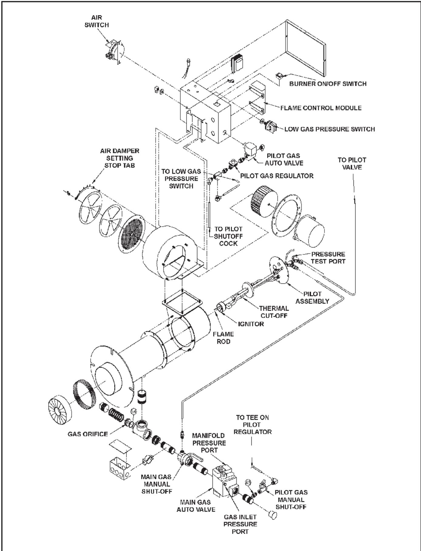
PREMIX LOW NO<sub>x</sub> BURNER - EXPLODED VIEW FOR GPG MODELS
