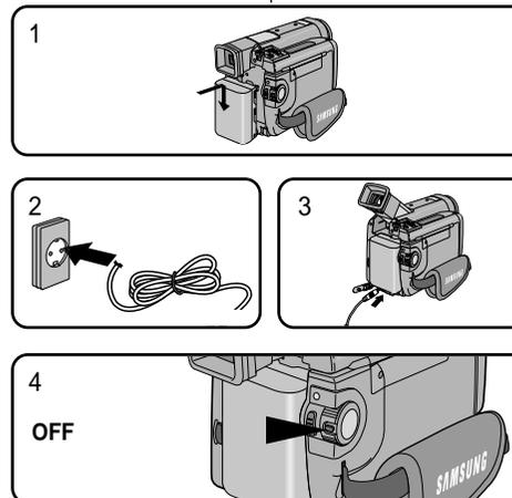
1. Schließen Sie den Akku an den Camcorder an (siehe Abbildung). Die Kontakte am Akku weisen dabei nach unten.
