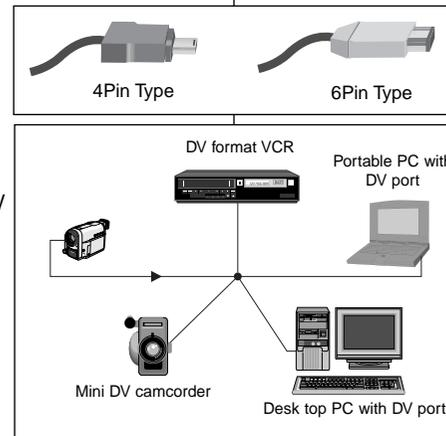
Über die Schnittstelle IEEE 1394, auch als "i.LINK" bezeichnet, können digitale Daten (Bild und Ton) mit hoher Geschwindigkeit zu anderen DV-Geräten (DV - Digital Video) mit der gleichen Schnittstelle übertragen werden. Damit können Sie den Camcorder beispielsweise an digitale Video-Hardware anschließen.
