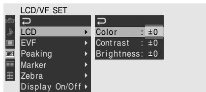
Réglez la couleur, le contraste et la luminosité du moniteur LCD à l'aide des options correspondantes du menu LCD : Color, Contrast et Brightness.
