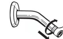
Appliquer deux ou trois spires de ruban d'étanchéité pour tuyauterie sur le filetage du tuyau d'alimentation de la douche, avant l'installation de la pomme de douche.
