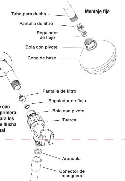
Los cabezales para duchas de marca Waterpik® vienen provistos de un regulador OptiFLOW® que limita el flujo máximo de agua a 2,5 galones por minuto a 80 lbs/pulg<sup>2</sup>, tal como lo dispone la ley federal de los EE.UU.
