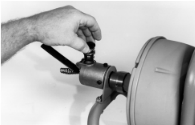
Figure 7 – Montrant le système d'avancement automatique attaché directement au support de montage
