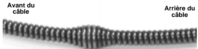
Figure 23 – Câble C-13-IC SB avec indicateur de fin de course à dos d'âne situé à environ 84 po de l'extrémité arrière du câble
