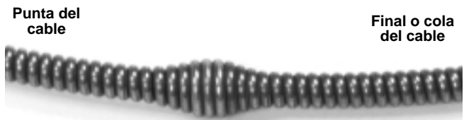
Figura 23 – La protuberancia o joroba en el cable C-13-IC SB está situada a unas 84 pulgadas de la cola del cable
