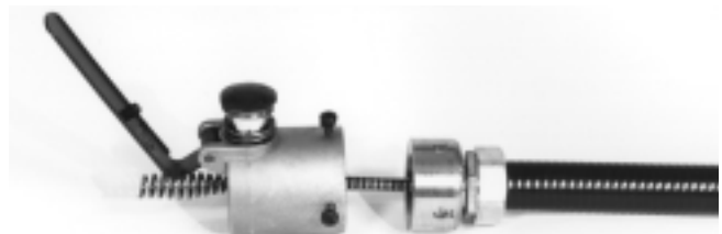
Figura 9 – Acoplamiento de la autoalimentadora a la manguera guía
