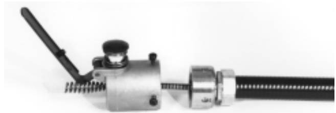
Figure 9 – Montage du système d'entraînement automatique sur le tuyau de guidage
