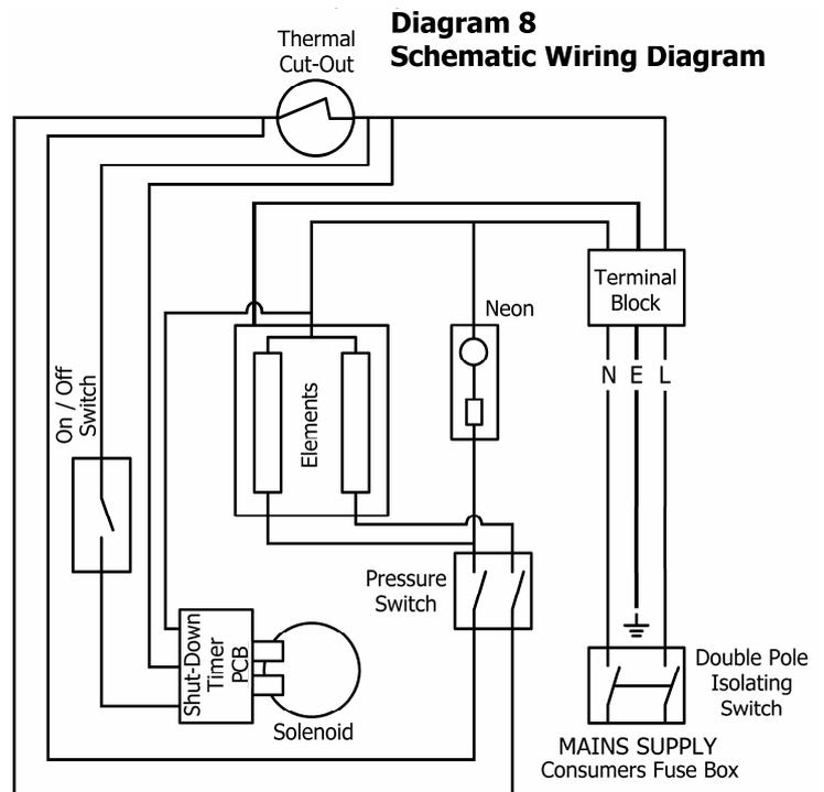
**Diagram 8 Schematic Wiring Diagram**
