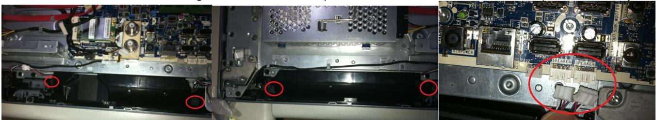
9) Disassemble CPU thermal module
