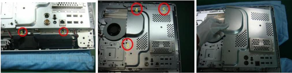
5) Disassemble HDD & ODD
