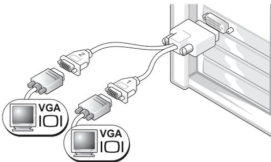
如果您的图形卡只有一个连接器，而您想将计算机连接至一台或两台 VGA 显示器，请使用适当的 Y 型电缆。
