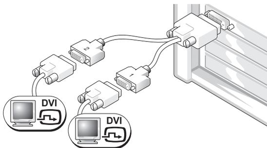
如果您的图形卡只有一个连接器，而您想将计算机连接至一台或两台 DVI 显示器，请使用适当的 Y 型电缆。
