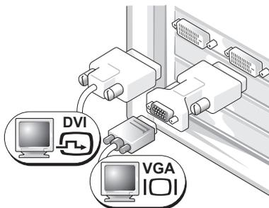
コンピュータの DVI コネクタの 1 個に VGA アダプタを取り付けて VGA モニターを接続します。
