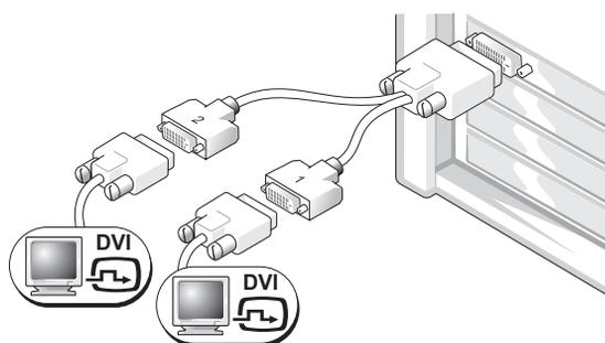
シングルコネクタ付きのグラフィックカードを装着したコンピュータに、1 台または 2 台の DVI モニターを接続するには、適切な Y ケーブルアダプタを使います。
