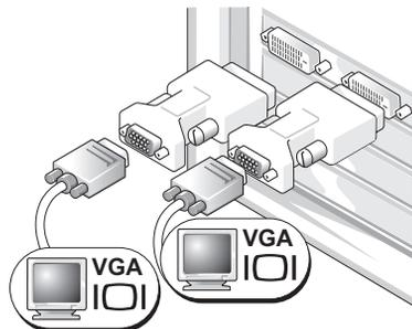
使用两个 VGA 适配器将两台 VGA 显示器连接至计算机上的 DVI 连接器。
