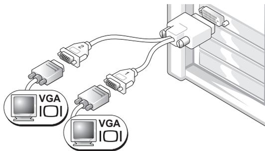
如果您的图形卡只有一个连接器，而您想将计算机连接至一台或两台 VGA 显示器，请使用适当的 Y 型电缆。
