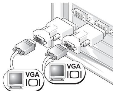
コンピュータの 2 個の DVI コネクタに 2 個の VGA アダプタを取り付けて、2 台の VGA モニターを接続します。
