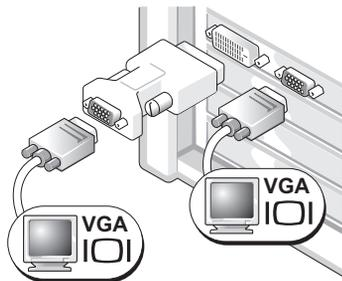
要将计算机连接至两台 VGA 显示器，请使用 VGA 适配器。
