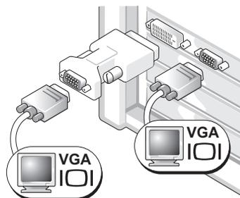
コンピュータに 2 台の VGA モニターを接続するには、VGA アダプタを 1 個使います。
