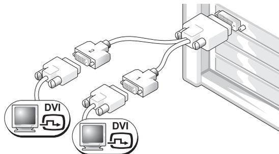
シングルコネクタ付きのグラフィックカードを装着したコンピュータに、1 台または 2 台の DVI モニターを接続するには、適切な Y ケーブルアダプタを使います。
