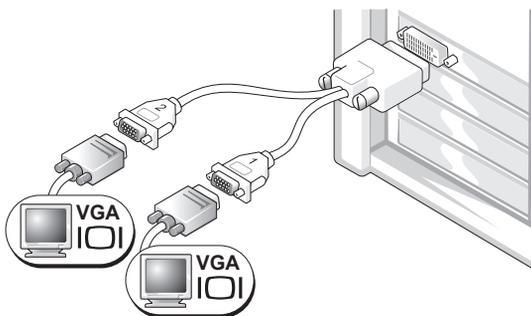
シングルコネクタ付きのグラフィックカードを装着したコンピュータに、1 台または 2 台の VGA モニターを接続するには、適切な Y ケーブルアダプタを使います。
