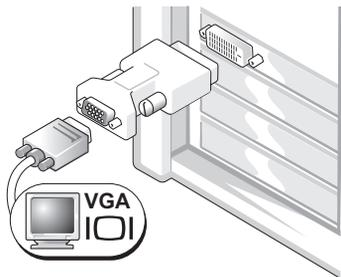
如果您具有单显示器图形卡，并且想将计算机连接至 VGA 显示器，请使用 VGA 适配器。
