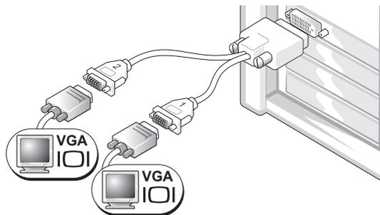
シングルコネクタ付きのグラフィックカードを装着したコンピュータに、1 台または 2 台の VGA モニターを接続するには、適切な Y ケーブルアダプタを使います。
