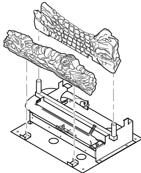
Figure 15 - Installing Logs to Grate (VF20)
