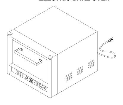
THIS UNIT MUST BE ELECTRICALLY GROUNDED IN ACCORDANCE WITH LOCAL CODES, OR IN ABSENCE OF LOCAL CODES, WITH THE NATIONAL ELECTRICAL CODE, ANSI/NFPA 70.
