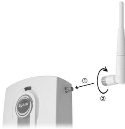
**Figure 3 Fixation des antennes**
