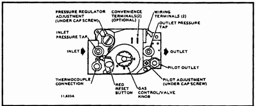
FIG. 16 - VR8204A VR8304M AUTOMATIC GAS VALVE
