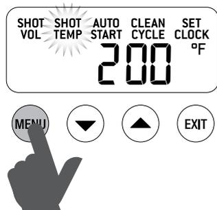
Appuyez sur les flèches HAUT ou BAS pour ajuster le réglage de température d'extraction. La température par défaut est de 200°F (93°C), mais peut être modifiée de 190-205°F (86-96°C).
