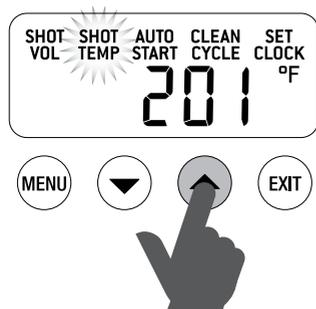
Le nouveau réglage de température d'extraction (SHOT TEMP) sera affiché sur l'écran ACL. Appuyez sur la touche EXIT pour reprogrammer la nouvelle température d'extraction.
