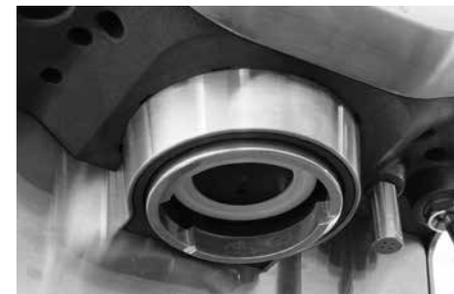
7. Réinsérez par ordre la plaque de dispersion, l'écran diffuseur et la vis. Avec vos doigts, tournez la vis dans le sens horaire sur 2-3 tours, puis serrez-la à l'aide de la clé Allen jusqu'à ce que la vis soit de niveau avec l'écran diffuseur.
