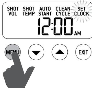
Appuyez sur une des flèches HAUT ou BAS pour ajuster l'heure. Pour accélérer le défilement, appuyez et maintenez enfoncée une des flèches HAUT ou BAS. Appuyez sur la touche EXIT pour régler l'heure.
