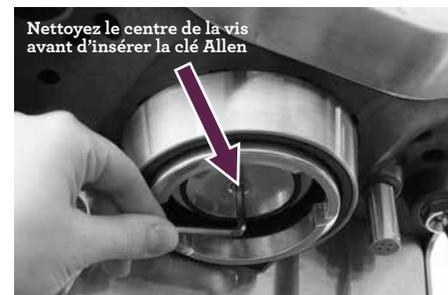
5. Une fois relâchée, retirez soigneusement la vis et retenez-la, de même que l'écran diffuseur en acier inoxydable et la plaque de dispersion noire. Rappelez-vous quel côté de l'écran diffuseur et de la plaque de dispersion est orienté vers le bas; cela facilitera le réassemblage. Lavez l'écran diffuseur et la plaque de dispersion à l'eau chaude savonneuse, puis séchez correctement.
