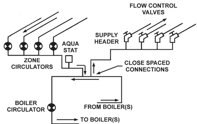
**SCHEMATIC OF THE LINEAR-TEMP® SYSTEM
