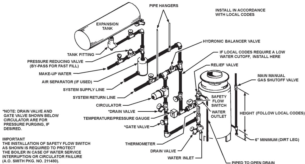
A TYPICAL BOILER INSTALLATION
