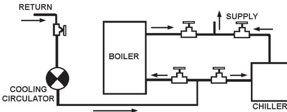
**SCHEMATIC SHOWING PROPER PIPING ISOLATION OF THE BOILER FROM THE CHILLER
