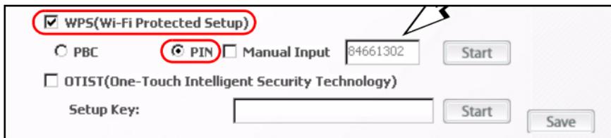
**2** Starta din APs konfigurationsverktyg, gå till skärbilden där du kan konfigurera WPS-inställningar och ange AG-220s PIN (en exempelskärm från ZyXELs NWA570N visas).
