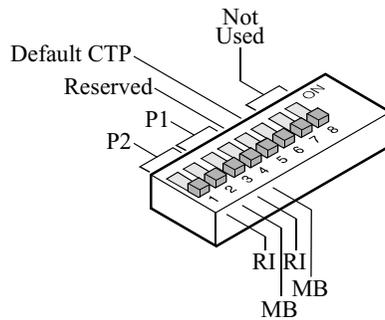
**Figure 2-8. Test Mode Switch**
