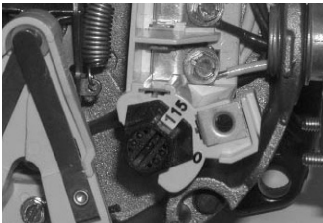
Figure 13 – Moteur réglé pour fonctionner sur le courant de 115 volts
