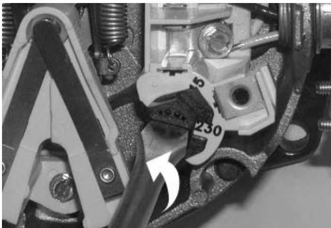
Figure 12 – Pour modifier le réglage de la tension
