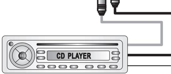
Conecte a la terminal de encendido remoto de la unidad fuente.
