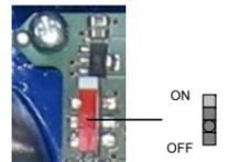
Figure 8 – ID-NET™ Termination Resistance Switch
