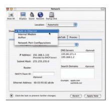
Set the IP address manually in the format 10.10.1.X (e.g. 10.10.1.200) and Subnet Mask 255.255.0.0.
