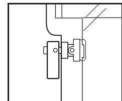
7. Verifique que la junta tórica en la tapa frontal esté correctamente montada en la ranura y presione la tapa frontal. Baje las dos hebillas en el sentido indicado por las flechas en la figura de la derecha para sellar la caja submarina.
