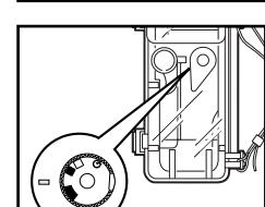
11. Cuando haya terminado de filmar, gire el disco de alimentación hacia la derecha para colocar el disco de alimentación de la videocámara en la posición de desconexión.
