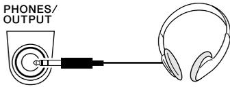
Les haut-parleurs du DD-65/YDD-60 sont automatiquement coupés lorsque vous introduisez une fiche dans cette prise. La prise PHONES/OUTPUT (Casque/Sortie) sert également de sortie externe. Vous pouvez brancher la prise PHONES/OUTPUT à un amplificateur de clavier, un système stéréo, une console de mixage, un magnétophone ou tout autre périphérique audio de niveau de ligne afin d'envoyer le signal de sortie de l'instrument vers ce périphérique.
