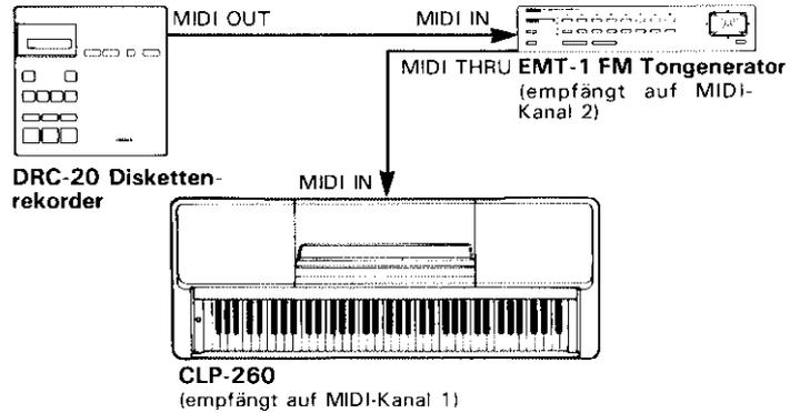
Um ein MIDI-System zusammenzustellen, müssen die MIDI-Kanäle von sendenden und empfangenden Geräten aufeinander abgestimmt werden. Außerdem gibt es eine OMNI-Funktion, die den Empfang auf allen 16 MIDI-Kanälen ermöglicht. In der OMNI-Betriebsart muß der Empfangskanal des empfangenden Geräts nicht auf den Sendekanal (außer für Empfang von Modusmeldungen) des steuernden Geräts eingestellt werden.
