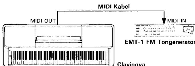
Für MIDI-Sequenzaufzeichnungen wird die gleiche Form von Datenübertragung verwendet. Ein Sequenzer, wie z.B. der Yamaha EMQ-1 oder der DRC-20 Diskettenrekorder kann zum Aufzeichnen der vom Clavinova empfangenen MIDI-Daten eingesetzt werden. Wenn die aufgezeichnete Sequenz dann wiedergegeben wird, "spielt" das Clavinova die aufgezeichnete Sequenz mit allen Einzelheiten nach.
