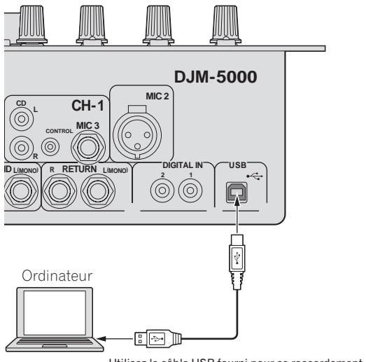
Utilisez le câble USB fourni pour ce raccordement.
