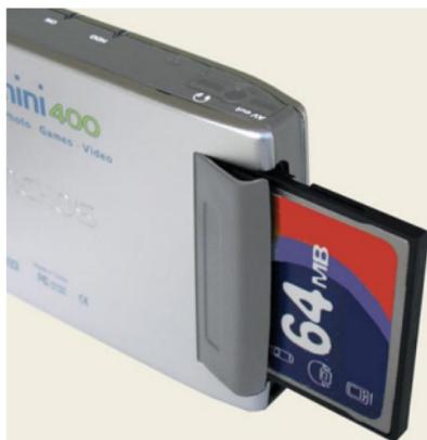
**\*Attention : afin de protéger les broches délicates de l'emplacement pour cartes CF, le clapet de protection ne s'ouvre que pour laisser passer une carte CF. Ne forcez pas le mécanisme ! Celui-ci ne doit pas s'ouvrir plus que le montre cette photo.**
