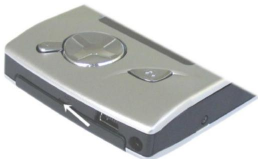
Pour transférer des images de votre appareil photo numérique directement sur le Gmini 400, vous devez insérer la carte CompactFlash™\* de votre appareil photo dans l'emplacement prévu sur le côté gauche du Gmini 400. Ouvrez le clapet protégeant l'emplacement en décrochant le loquet central avec votre ongle.
