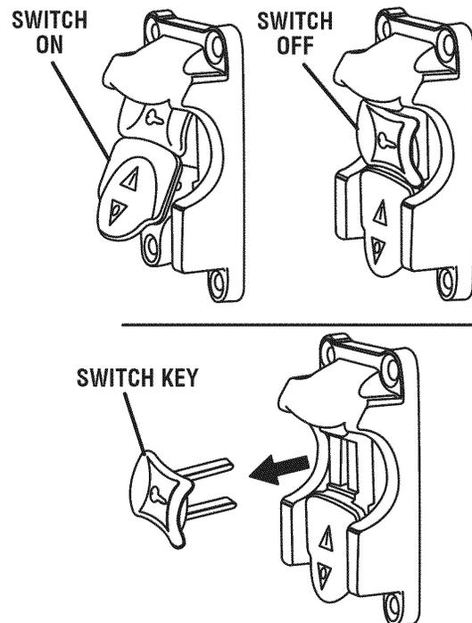
SWITCH IN LOCKED POSITION
