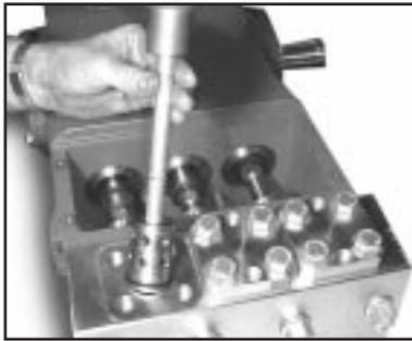
4) Take out valve assemblies (52 & 51) using either tool (part #07704) or a stud bolt.
